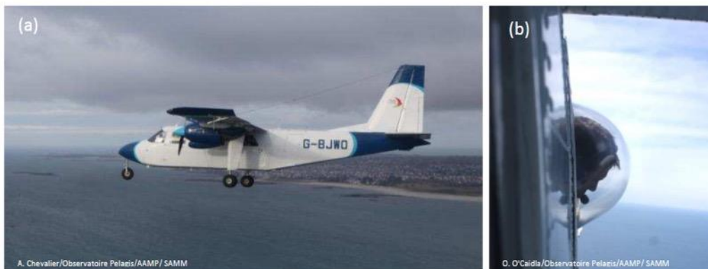
Figure 4 : (a) Avion à ailes hautes ; (b) hublot-bulle (source : Pettex et al. 2014).
